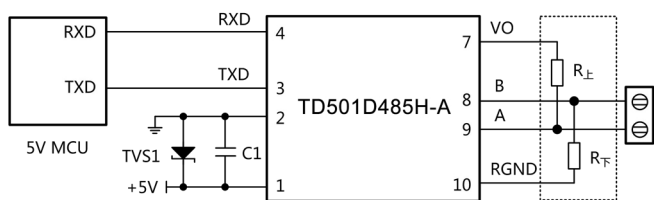
图 1.MCU 5V供电应用电路
